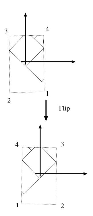
$$\begin{pmatrix} x' \\ y' \\ 1 \end{pmatrix} = \begin{pmatrix} -1 & 0 & 0 \\ 0 & 1 & 0 \\ 0 & 0 & 1 \end{pmatrix} \begin{pmatrix} x \\ y \\ 1 \end{pmatrix}$$
